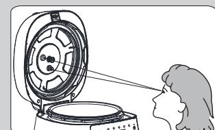
必须对止开阀孔、防堵螺母、排气孔做定期检查, 以确保其不被堵塞。
