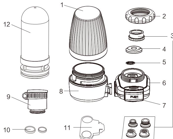
1. 滤瓶上盖      7. 按键 (淨水/原水切换开关)
