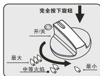
**最大火力：**完全按下旋钮，并沿着逆时针转到“
