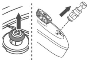
③ 将止开安全阀密封圈向上取出，再从止开安全阀阀口处取出止开安全阀杆。
