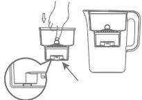
滤芯装入原水桶中，并压紧（原水桶卡位顶住滤芯底部），再将原水桶装入壶身中；盖水壶上盖。
