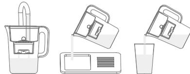
打开原水进水口，接入自来水后实施过滤，过滤水至净水最佳水位，前两次滤出的水倒掉（在最初2次滤水中出现炭粉是正常现象），净水壶可正常使用。
