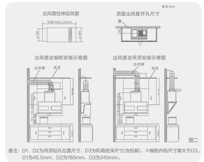
备注：D1、D2为吊顶钻孔位置尺寸，D3为机箱进深尺寸(含机脚)，※橱柜内包尺寸需大于D3。D1为45.5mm，D2为180mm，D3为340mm。
